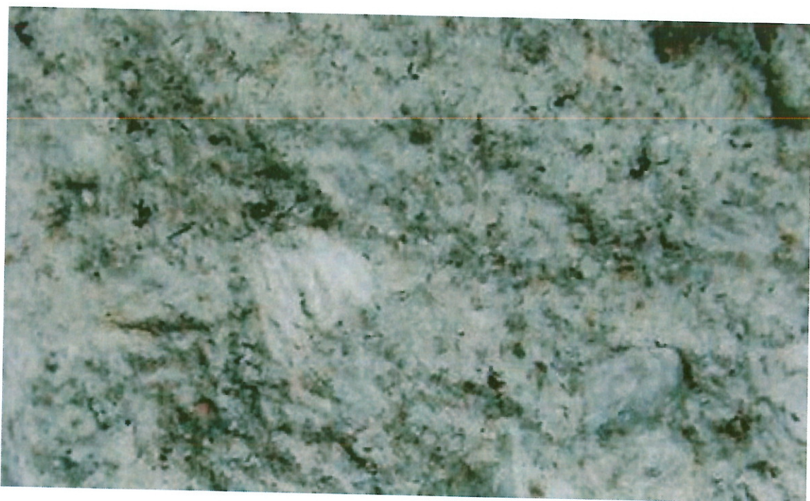
Foto č.1.: Svetlosivý rvolitový pemzový tuf -- vzorka č. 1 Hornina je vytvorená prevažne ostrohranými úlomkami pemzy, sopečného skla, ktoré sú stmelené teplom. Zrná minerálov sa vyskytujú v hornine iba veľmi zriedkavo. Makroskopicky sú rozpoznateľné ešte drobné tmavé úlomky obsidiánov a oxidy železa, ktoré tvoria v hornine drobné škvrny. Hornina je drobnochopovitá. Obýčajné svetlo, zväčšenie 5 x.
