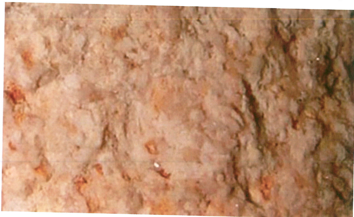
Foto č. 4.: Vzorka č. 2 svetlokrémový organodetrítický vápenc — z dekoratívneho vlysu. Pri zväčšení 15x sú viditeľné vápenaté úlomky schrádek morských organizmov. Tieto sú stmelené rovnakým vápenatým tmelom. Pri bežnom pohľade hornina pripomína svetlý pieskovec. Na povrchu sa môžu jemne lesknúť drobné kryštály kalcitu. Zväčšenie 15 x, denné svetlo.
